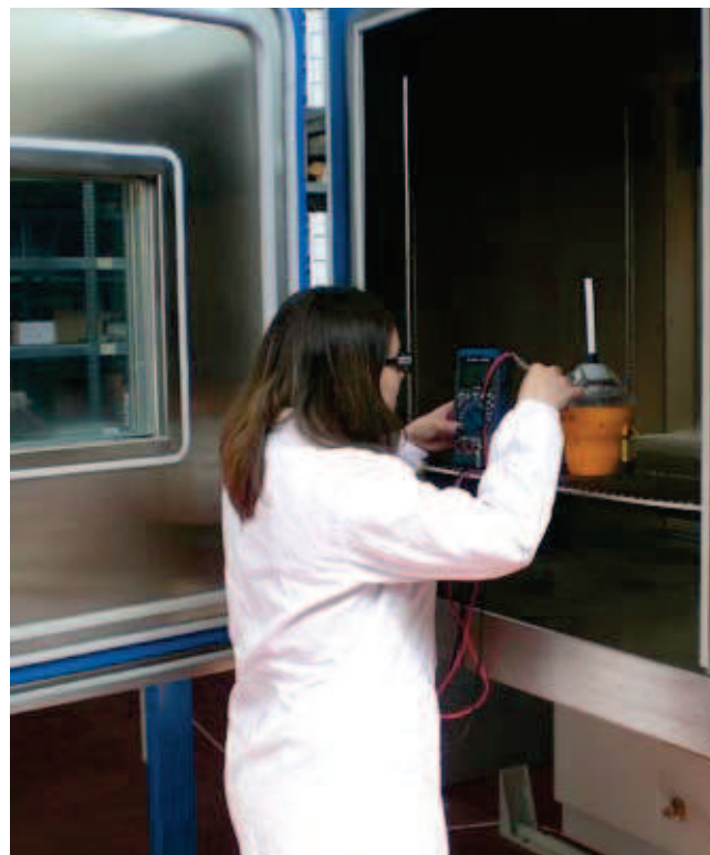
Un Epirb sottoposto ad uno stress termico. WamBlee dispone al suo interno di un sistema di camera climatica in grado di simulare variazioni di temperatura da -80 a +180 Gradi, con un salto termico di 15 gradi/minuto e una umidità relativa tra 0 e 99%. Nella stessa camera climatica è previsto un simulatore di vibrazioni e urti
